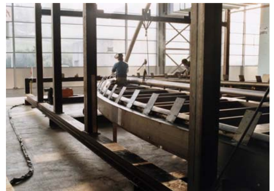
Die Einzelteile der Rahmen wurden in einem großen Montage-rahmen millimetergenau fixiert und dann zusammengebaut.
