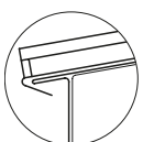
Traufabschluss, stehend gerade (nur für optisch anspruchslöse Anwendungsbereiche)
