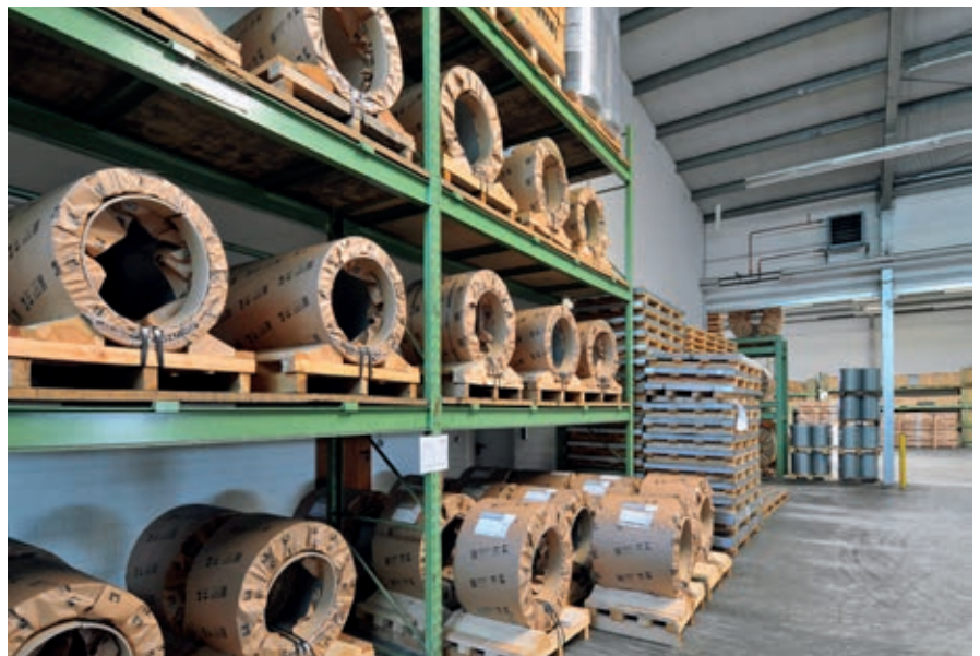
Lagerung Coils mit Lagerhölzern
