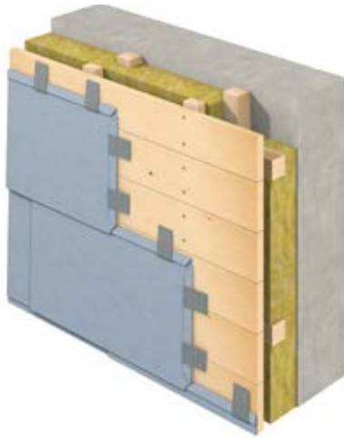
Skizze Holzunterkonstruktion (Beispielraute Achsmaß 333/600 mm)
