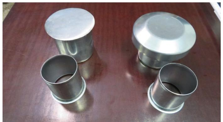
Einzelteile für löttechnische Einfassung – links spengler-technisch gefertigter Deckel, rechts vorgefertigter Deckel
