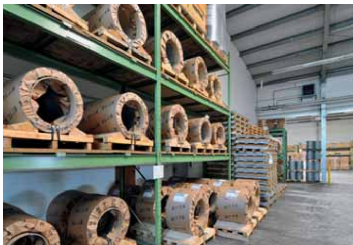
Lagerung Coils mit Lagerhölzern
